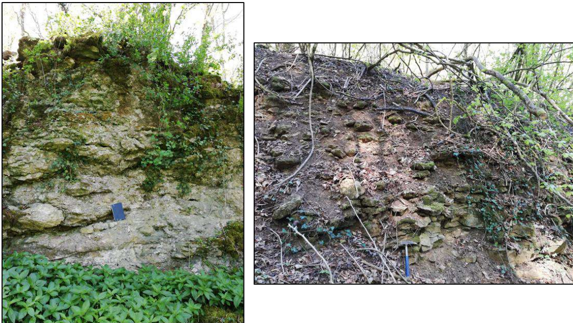
Illustration 22 : Calcaires mal stratifiés à débit grossier (à gauche) et à débit en plaquette (à droite)
