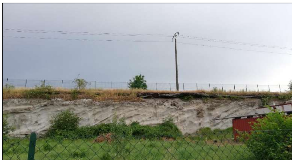
Illustration 25 : Profil vertical au sein d'une formation de crassier présentant un aspect induré
